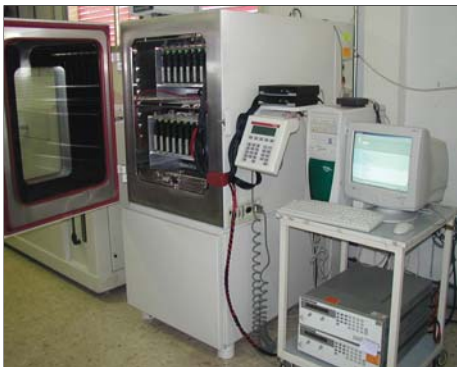
Cicli termici in camera climatica
